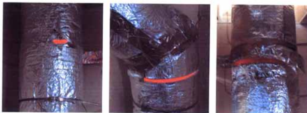
Particolari del distacco del nastro adesivo alluminizzato durante la prova.
